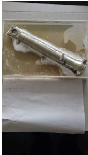
PM14:07~14:15 微粒の泡が発生 油が分解されているのが解る。
