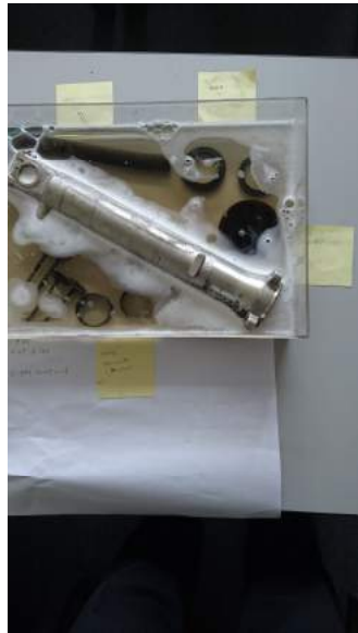
PM14:07~14:15 微粒の泡が発生 油が分解されているのが解る。
